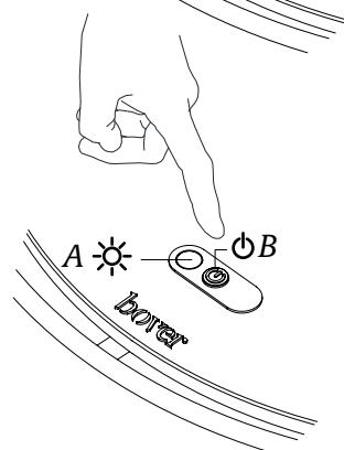
Das Dimmen der Lichtleistung funktioniert bei jeder Farbtemperatur, und die Farbe der LED A variiert je nach der gewählten Temperatur.
